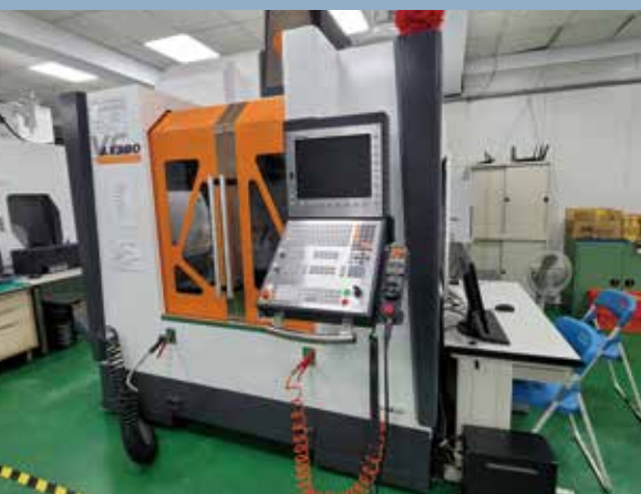
▲智慧機械產業發展中心(SMDC)為逢甲大學智慧機械之關鍵重地，教學設備相當完整。圖為五軸加工機。
