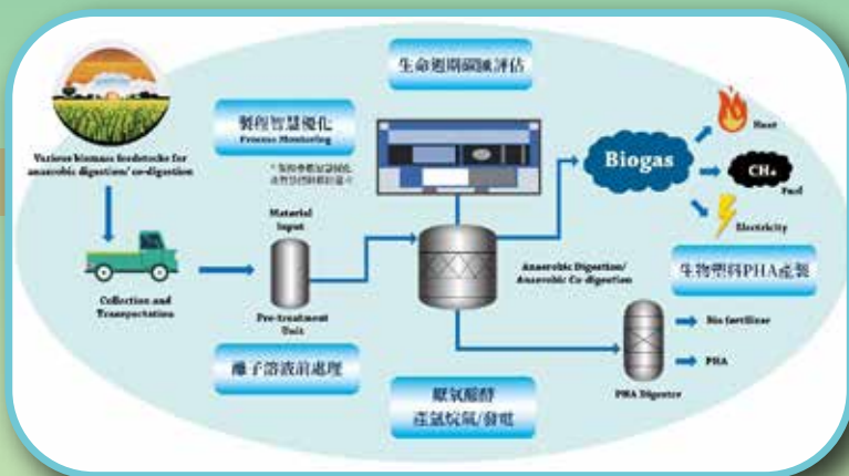
▲智慧化複合生質料源產製氫烷氣 / 生物塑料之系統開發與全生命週期減碳評估概念。
